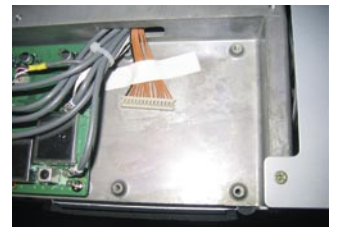
Widok na płytę pośredniej częstotliwości dodatkowego odbiornika. Na małym zdjęciu widać miejsce na włożenie jednego filtru potrzebnego w FT-2000 (YF-122C 500 Hz lub YF-122CN 300 Hz)
